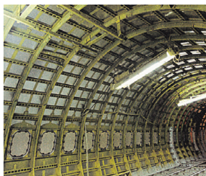
Taśma wyciszająca 3M™ 435 naklejona pomiędzy wręgami i podłużnicami kadłuba samolotu zmniejsza zmęczenie materiału na skutek wibracji oraz hałas wewnątrz kabiny pasażerskiej
