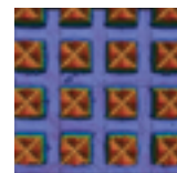
468LA – najnowsza technologia mikroreplikacji, która wymaga mniejszego nacisku jednostkowego, co zwiększa żywotność i wydajność dysku
