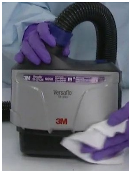
Figure 3: Wycieranie zewnętrznej powierzchni akumulatora
